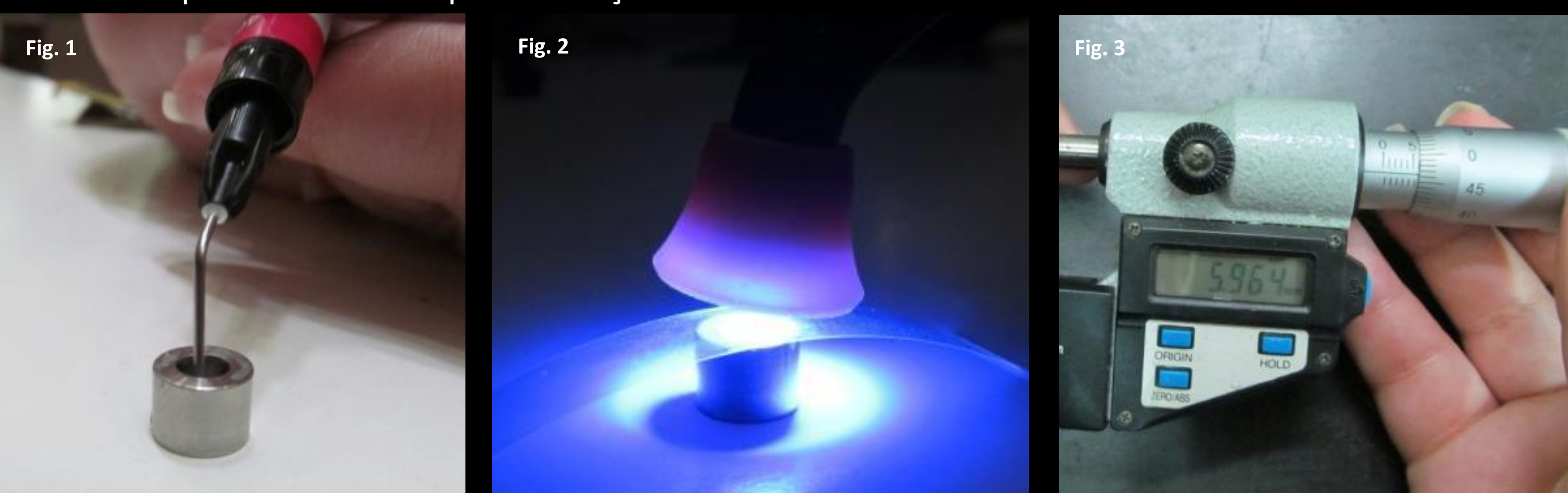
Avaliação da profundidade de polimerização segundo a norma ISO4049:2000. Figura 1 - Preenchimento do provete com o compómero. Figura 2 – Polimerização da amostra. Figura 3 - Medição da parte endurecida no micrómetro.
